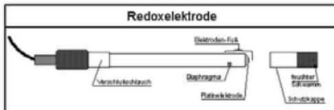
Um dauerhaft genau Messergebnisse zu erreichen, sind die oben genannten Maßnahmen sowie ein jährlicher Wechsel der Redoxelektrode vorzunehmen.
