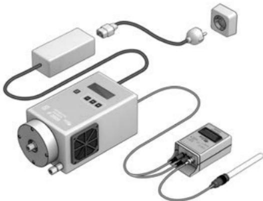
Ein Sander Ozonisator der Baugröße P muss mit der im Lieferumfang des Ozonisators P enthaltenen Verbindungsleitung mit dem Redoxpotential Mess- und Steuergerät verbunden werden.
