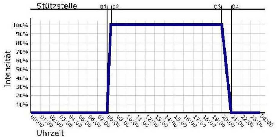
Für ein komplettes Programm benötigen Sie somit mindestens 4 Stützstellen. Ein Programm (hier die Werkseinstellung) sieht demnach wie folgt aus:
