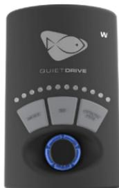
Stellen Sie bei Erstverwendung des Kurzpulsmodus' mithilfe des Drehreglers die maximale Pumpengeschwindigkeit ein und drücken Sie dann zum Speichern die SET-Taste. Die LEDs beginnen zu blinken und zeigen eine Pulsfrequenz zwischen 0,2 und 2 Sekunden an. Stellen Sie nun mit dem Drehregler die Pulsfrequenz ein.
