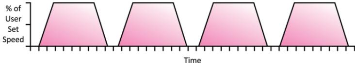
dass der Wellengang gespeichert wurde, langsam blau blinkt. Dieser gespeicherte Wellengang wird auch beim EcoSmart-Modus verwendet: Zur Feinjustierung des Wellengangs drücken Sie MODE, um die Welle zu beschleunigen und OPTION, um ihn zu verlangsamen. Speichern Sie den Wellengang mit SET.
