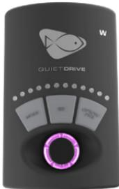
Stellen Sie bei Erstverwendung des Wirbelmodus' mithilfe des Drehreglers die maximale Pumpen- geschwindigkeit ein und drücken Sie dann zum Speichern die SET-Taste. Die LEDs beginnen zu blinken und zeigen eine Pulsfrequenz zwischen 2 Sekunden und 2 Stunden. Stellen Sie nun mit dem Drehregler die Pulsfrequenz ein. Die ersten sechs LEDs stehen für 2 Sekunden bis 2 Minuten.
