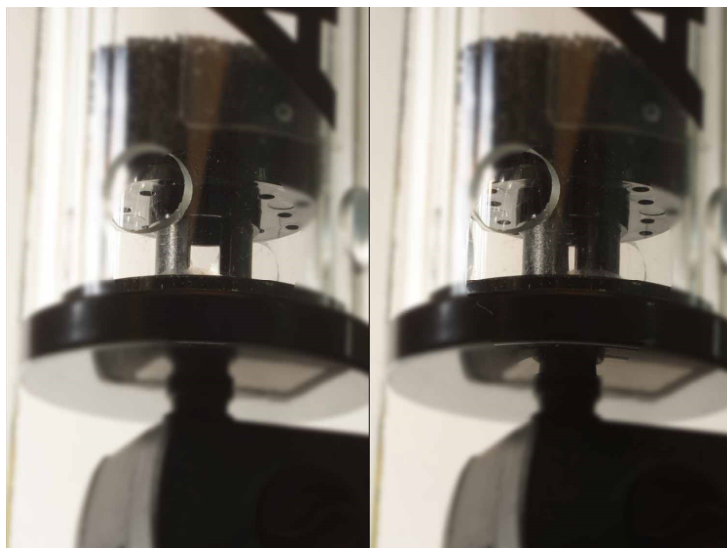
Фото 2: Управление протоком происходит вращением кнопки сверху реактора. С её помощью изменяется размер щели, через которую проходит вода. Помпа просто надевается снизу.
