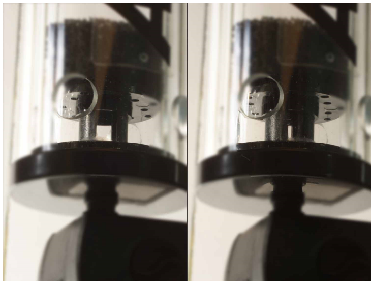
Foto 2: Regelen van de stroomsnelheid door het verhogen of verlagen van de spleetbreedte in de reactor door de hendel van het apparaat te verdraaien. De pomp wordt eenvoudig aangesloten van onderen.
