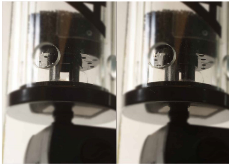
Rys. 2: Przepływ reguluje się przez zmianę szerokości przerwy wewnątrz reaktora. Regulacji dokonuje się przekręcając pokrętko na górze reaktora. Pompa jest podłączona na dole.
