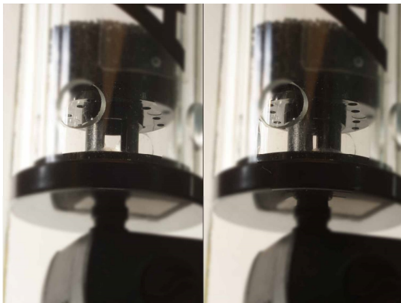
Fig. 2: Regolazione del flusso tramite cambio di altezza dell'apertura all'interno del reattore, girando la maniglia sulla cima del prodotto. La pompa e' collegata alla base del reattore.
