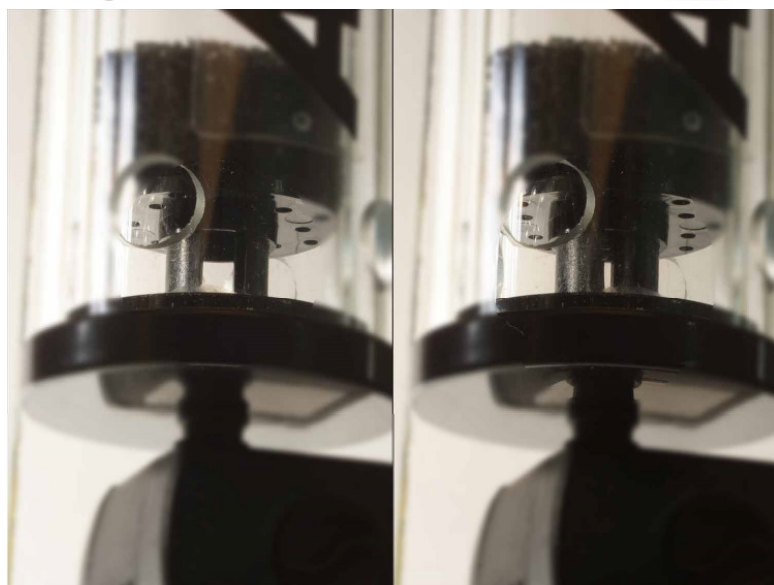
Фото 2: Управление протоком происходит вращением кнопки вверху реактора. С её помощью изменяется размер щели, через которую проходит вода. Помпа просто надевается снизу.
