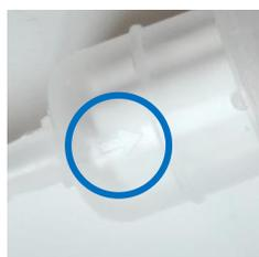
Dabei unbedingt darauf achten, dass der Schlauch bis zum Anschlag an das Filtergehäuse aufgesteckt wird. Die Filter-Anschluss-Stutzen haben einen etwas größeren Durchmesser als der Probenschlauch innen, um ein versehentliches Lösen des Schlauchs zu verhindern.
