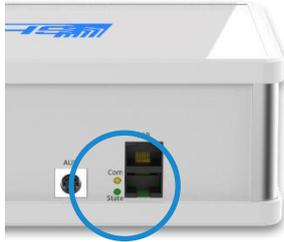
Auf der Gehäuserückseite des *KH Directors* befinden sich zwei Status-LEDs, die über die *PAB*-Kommunikation Aufschluss geben.
