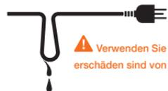
⚠ Verwenden Sie stets eine Tropfschlaufe. Wasserschäden sind von der Garantie NICHT gedeckt.
