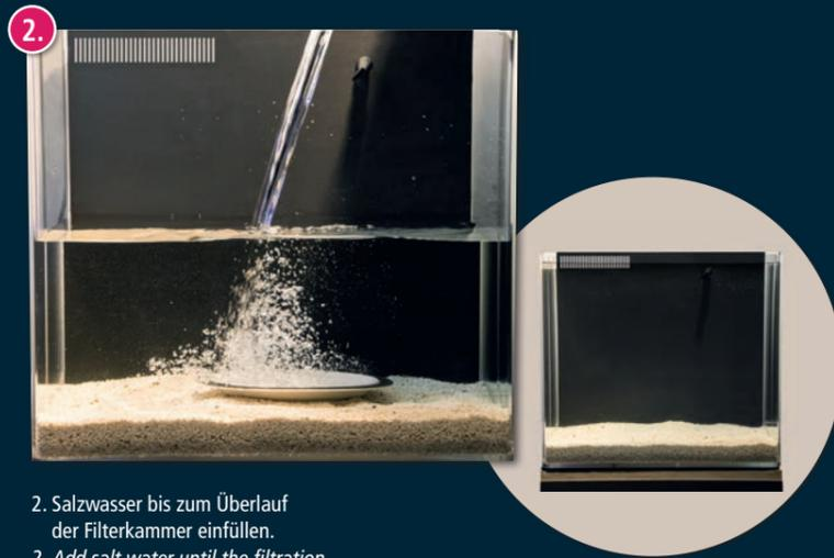
2. Salzwasser bis zum Überlauf der Filterkammer einfüllen.
