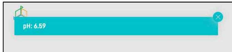
Wenn die Differenz zwischen dem Messergebnis und dem pH-Wert der Lösung größer als 0,05 ist, sollte der Kalibriervorgang wiederholt werden.
