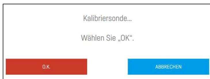
Nehmen Sie dann die Sonde aus der pH4-Lösung, spülen Sie sie mit RO-Wasser ab und tupfen sie trocken und tauchen Sie die Sonde in die pH7-Lösung ein.
