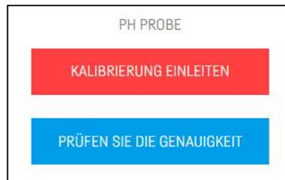
Tauchen Sie die Sonde in die pH4-Lösung ein, und warten Sie 60 Sekunden (Stabilisierungsprozess vor der Messung).
