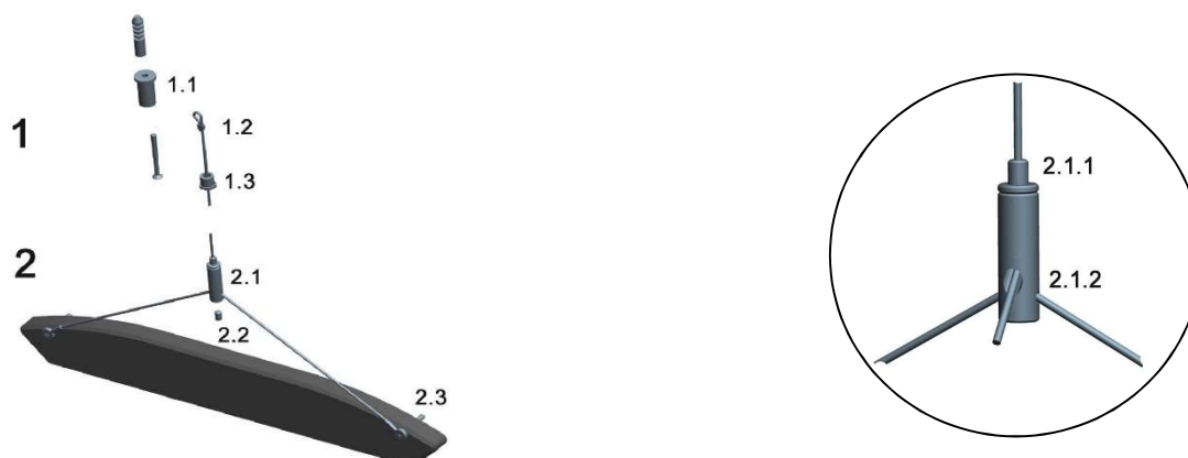
Rys. 1: Stalowe zawiesia aquafit 2 (art.-No. 80401)
