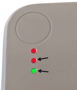
Fig. 2b: De twee onderste LEDs moeten gelijktijdig knipperen als u direct wilt verbinden met de pomp.
