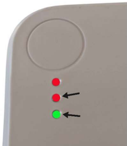
Fig. 2b: I due led inferiori devono lampeggiare contemporaneamente se si vuole eseguire un collegamento diretto alla pompa.
