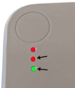
Fig. 2b: Los dos LEDs inferiores deben parpadear simultáneamente si quiere conectarse directamente a la bomba.
