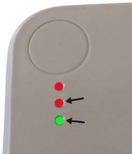
Рис. 2б: Оба нижних LED индикатора должны одновременно мигать. Только в этом случае возможна связь с помпой напрямую.
